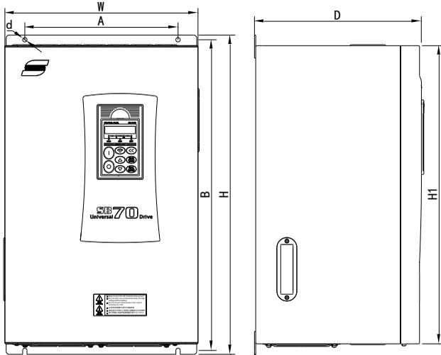
SB70PM400及以上、SB70PM355T6C及以上功率等级柜式单机机型外形图如下：
