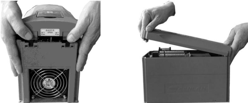
拆卸时，先取下操作面板，然后如左图所示两手同时按下机箱顶端的两个卡扣，向上稍微用力即可取下盖板。
