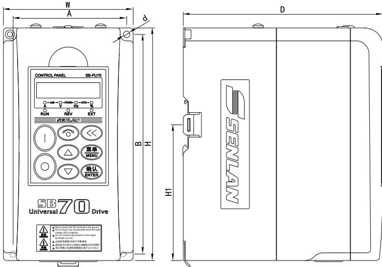
SB70PM4T2、SB70PM5.5T2、SB70PM5.5T4~SB70PM15T4挂单机机型外形图如下：
